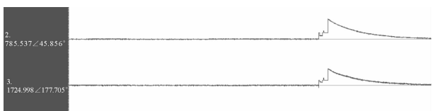
图 16 合 DS 23 隔离开关时合并单元 保护电流信号录波输出
