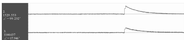
图 17 分 DS 23 隔离开关时合并单元 保护电流信号录波输出
